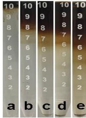
Şekil 54. Fe 3 O 4 nanopartikülün sükroz gradientinde 5 dk santirüj ile ilerlemesi a) RCF=0 b) RCF=500 g c) RCF=1500 g d) RCF=3000 g e) RCF=4149 g, t=45 dk
