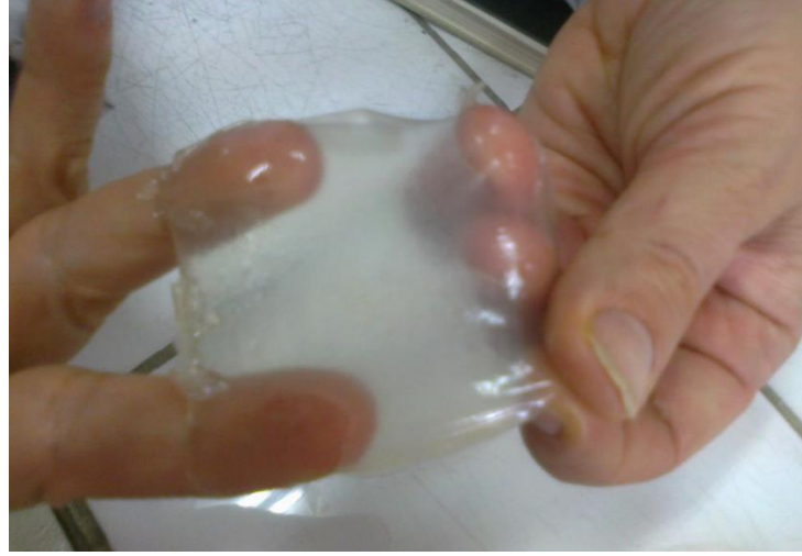
Şekil 4.3. Atık limon kabuklarından hazırlanan elastik yenilebilir film örneği
