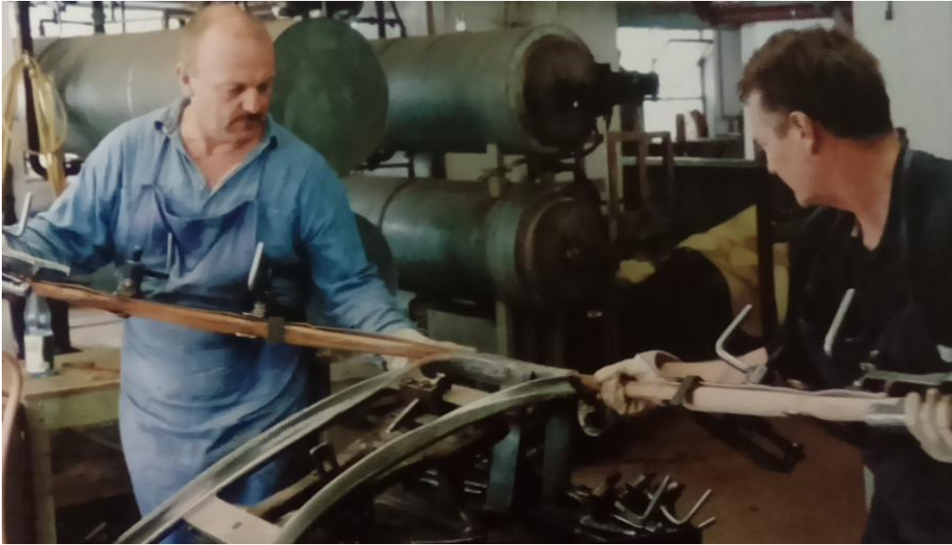
Şekil 3. Buharlanmış ahşap malzemenin kalıba yerleştirilme aşamasında uyumlu hareket eden ustalar [14]
