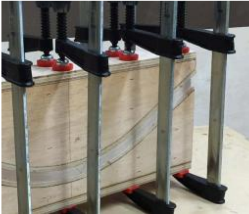
Şekil 6. Kalıba işkenceler ile sabitlenmiş tutkallanmış ahşap katmanları [18]
