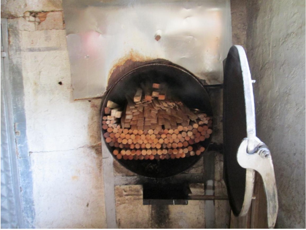
Şekil 2. Türkiye’de ahşap bükme mobilya üretimi yapan bir firmanın buharlama işlemini yaptığı kazan (Özdemir,N., 2018, Firma 4)
