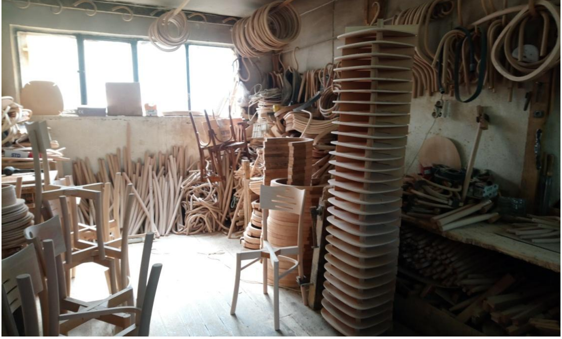
Şekil 43. Firmanın üretmiş olduğu bazı sandalyelerin bükülmüş parçaları (Özdemir, N., 2018, Firma 1, Bolu)
