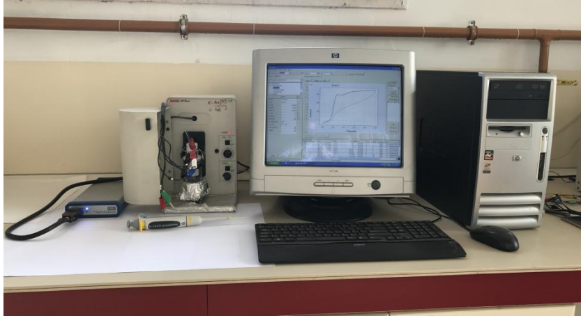
Şekil 3.2. Elektrokimyasal ölçümlerde kullanılan elektroanalizör ve elektrot sistemi
