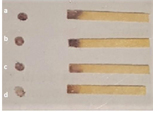
Şekil 4.17 Cam fiber filtre membranının plazma ile uygulanması a. 22 mg/dL, b. 10 mg/dL, c. 4 mg/dL, d. Fenilalanin eklenmeyen plazma.
