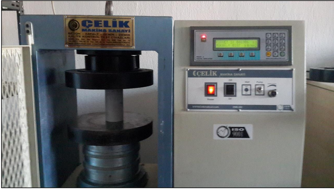
Şekil 3. 6. İşletmeden getirilen numuneler üzerinde yapılan tek eksenli basınç dayanımı deneyi
