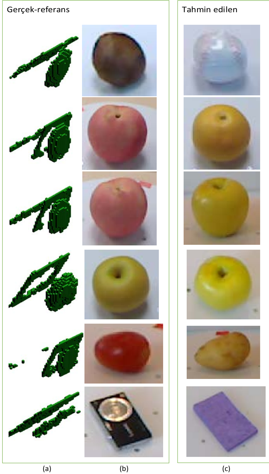
Şekil 4.9. Washington RGB-D Nesne veri kümesindeki yanlış sınıflandırılmış kategori örnekleri. RGB görüntüler görsel amaçlı kullanılmıştır. Önerilen çalışmada sadece derinlik görüntüleri kullanılmıştır. (a) Karıştırılan nesnenin hacimsel temsili. (b) Gerçek-referans örneğinin RGB görüntüsü. (c) Yöntemin yanlış öngördüğü nesne kategorisine ait örnek bir RGB görüntü.
