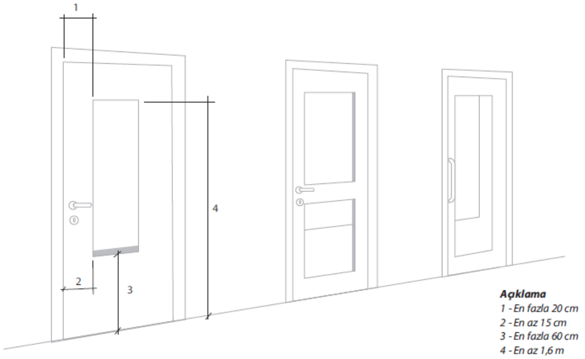
(Şekil 23. TS 9111'e göre cam panelli giriş kapısında gerekli işaretleme önlemleri.)
