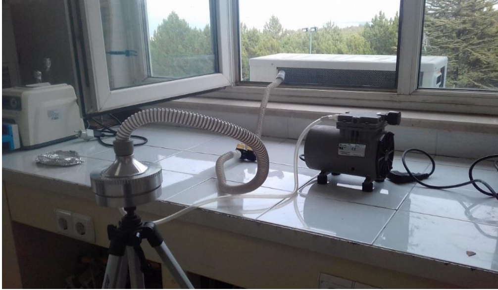
Şekil 3.7. Havanın bakteriyolojik örnekleme amacıyla kullanılan vakum pompası ve impaktörün görünümü
