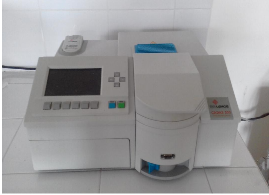
Şekil 2.2. Bulanıklık ölçümü için bölümümüzde kullanılan UV spektrofotometre (Jen Wat 6105 UV/Vis. Model) cihazından görünüm
