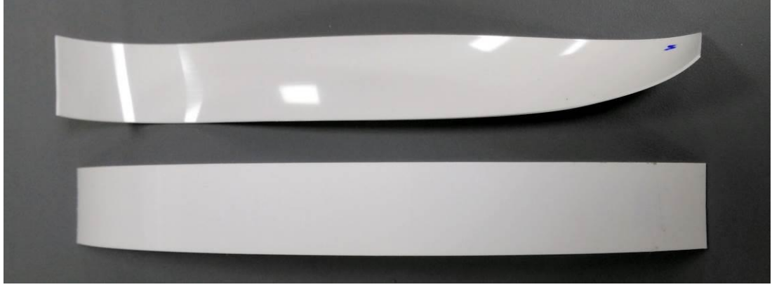
Şekil 4.11. 2B Numunesi Boyutsal Kararlılık Deney Sonu Durumu [Fotoğraf: Burak Mirac Yılmaz, 2018]
