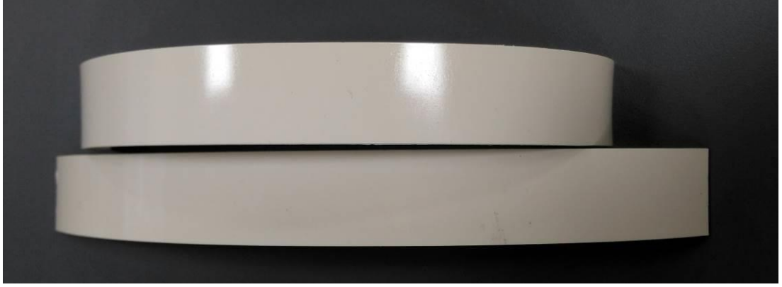
Şekil 4.9. 1B Numunesi Boyutsal Kararlılık Deney Sonu Durumu [Fotoğraf: Burak Mirac Yılmaz, 2018]
