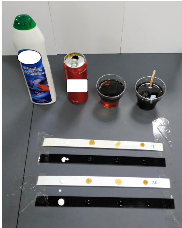
Şekil 4.6. Lekelendirici Uygulanmış Numuneler [Fotoğraf: Burak Mirac Yılmaz, 2018]
