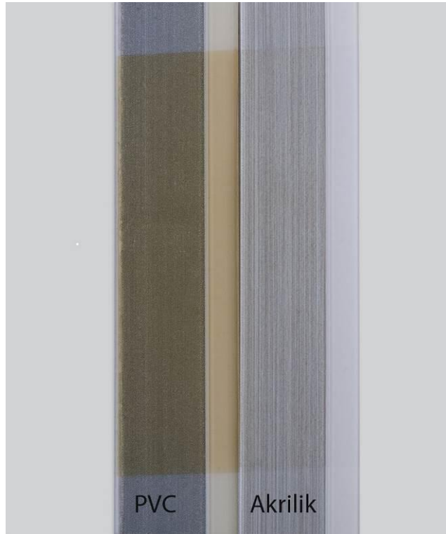
Şekil 2.9. PVC ve Akrilik malzeme üzerindeki solma [11]
