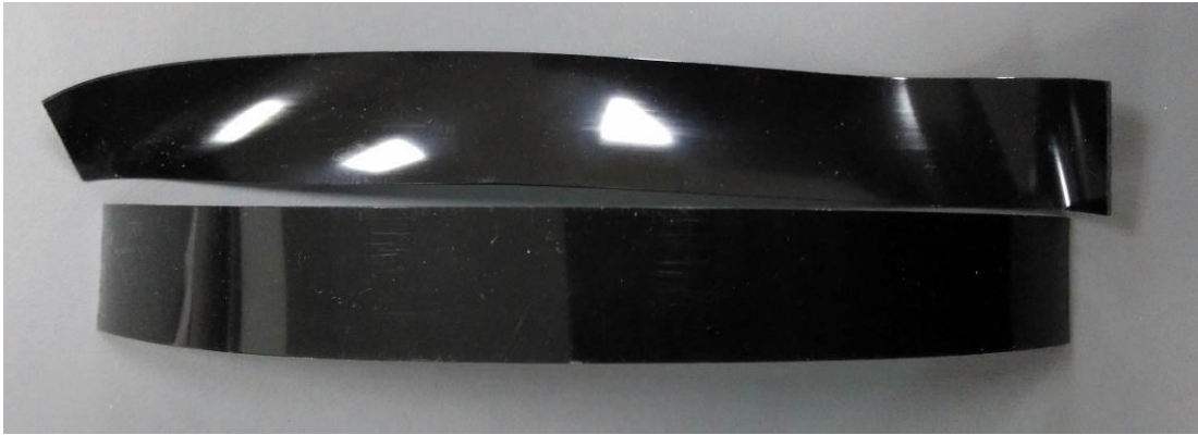
Şekil 4.12. 2S Numunesi Boyutsal Kararlılık Deney Sonu Durumu [Fotoğraf: Burak Mirac Yılmaz, 2018]
