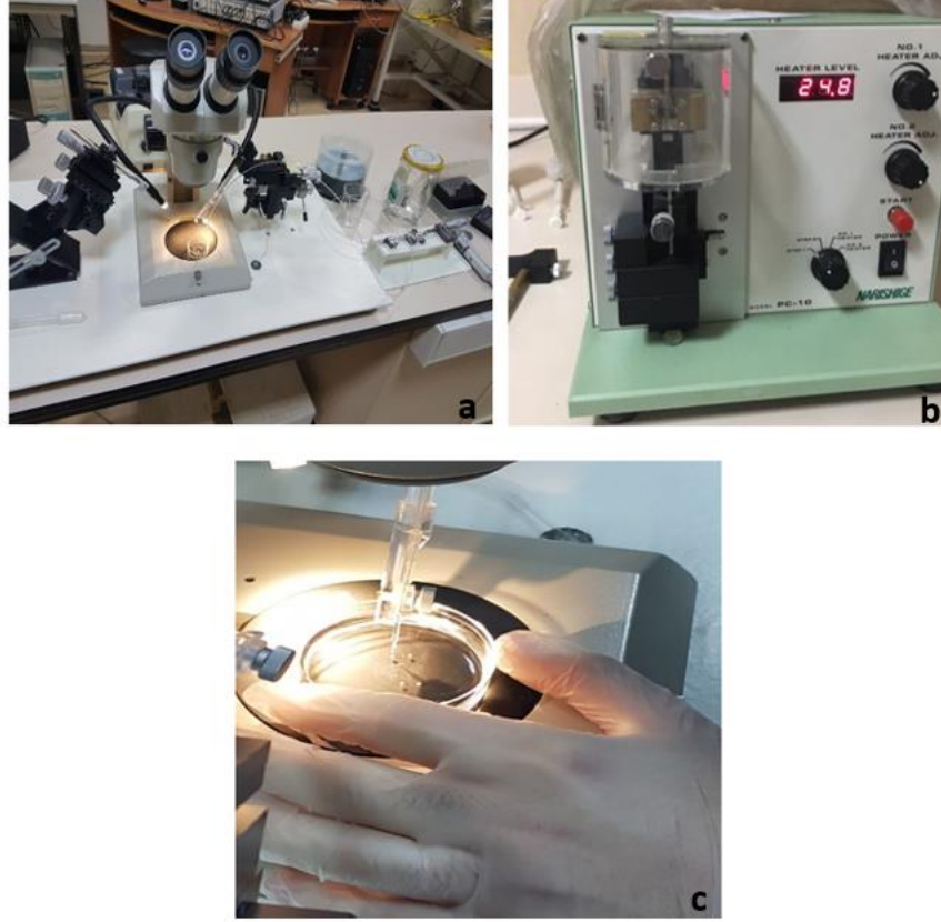
Şekil 3.10. cRNA enjeksiyon basamağına ait görüntüler a. İnjeksiyon sisteminin genel görüntüsü b. İnjeksiyon için kullanılan uçların hazırlanma aparatı c. İnjeksiyon uygulama anına ilişkin görüntü.
