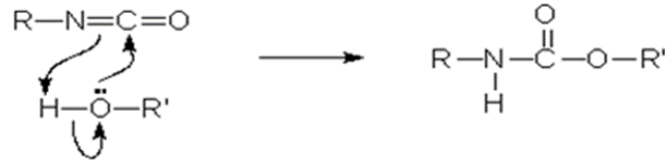
Şekil 3.2 İzosiyanat ve poliöl arasında gerçekleşen üretan reaksiyonu
