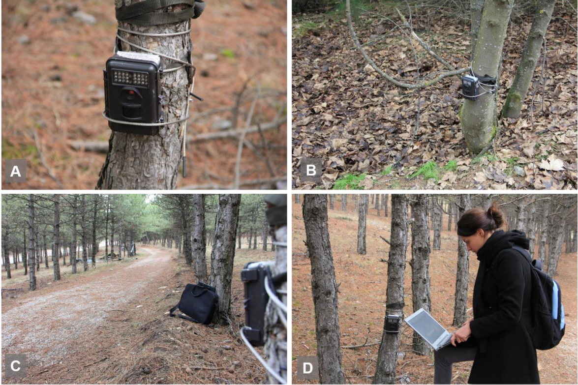
Şekil 3. 2. Çalışmada kullanılan fotokapanların yerleştirilmesi. A , ağaca belli bir açı ile sabitlenmiş Bushnell Trophy fotokapan; B , fotokapanın ağaçtaki konumu ve yerden yüksekliği; C , fotokapan yaklaşık kadrage alanı; D , fotokapandan veri aktarımı
