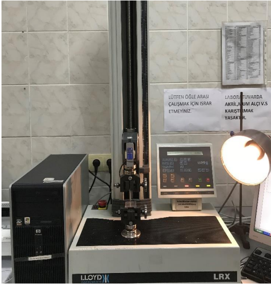
Şekil 3.12. Push-out testi için kullanılan universal test cihazı.
