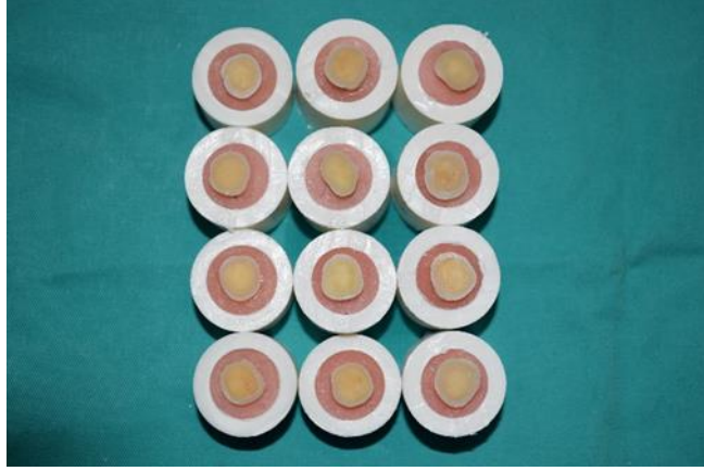
Şekil 3.1. Akrilik bloklara yerleştirilmiş, hassas testere ile dentin yüzeyleri açığa çıkarılmış numuneler
