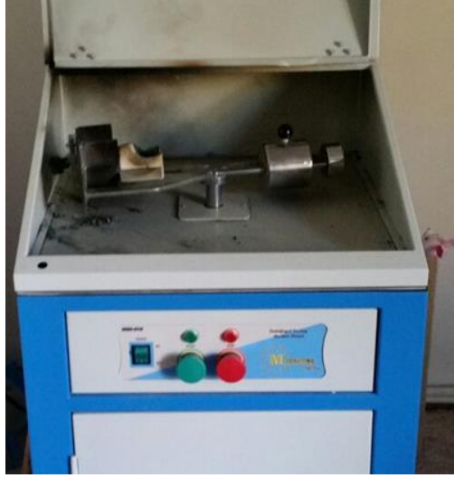
Şekil 3.3. Çalışmamızda kullanılan santrifüjlü döküm fırını.
