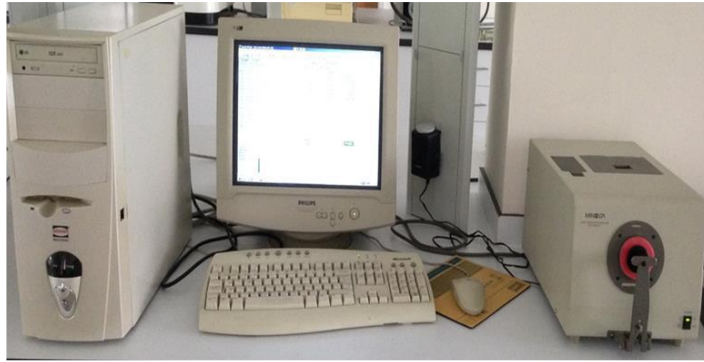
Şekil 3.11. Çalışmamızda örneklerin renk analizinde kullanılan spektrofotometre
