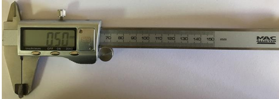
Şekil 3.5. Hazırlanan metal altyapıların kalınlığının dijital kumpasla ölçülmesi.
