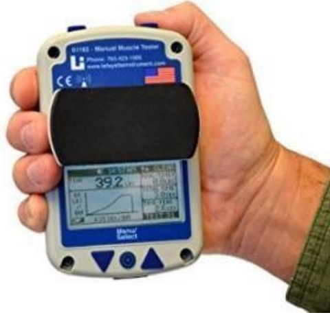
Şekil 3.9. Lafayette el dinamometresi (64).
