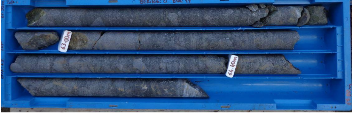
Şekil 2.6. 3. Boğaz Köprüsü güzergahında açılmış olan sondaja ait karot sandığı fotoğrafı [33].
