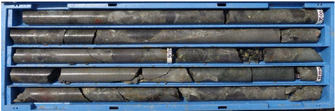
Şekil 2.2. Akyazi Tüneli güzergahında açılmış olan sondaj kuyusuna ait karot sandığı fotoğrafı [30].
