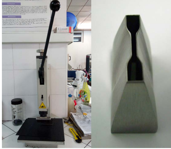
Şekil 3.4. Zwick ZC020 kesme presin ve ASTM D412 tip D kesme kaşığı
