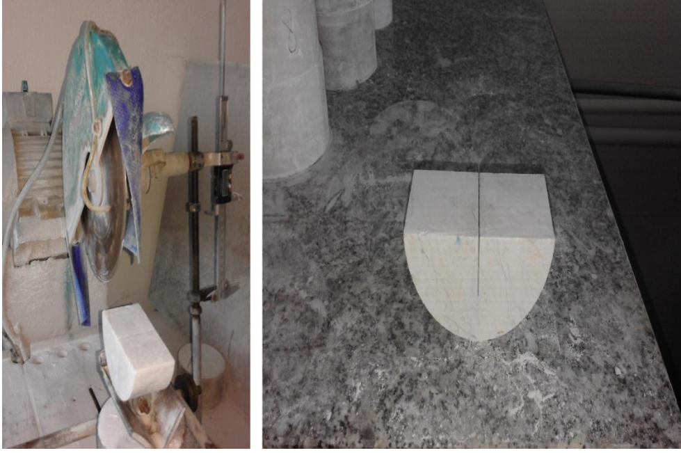
Şekil 4. 7 Dairesel testere ve çentikli numune
