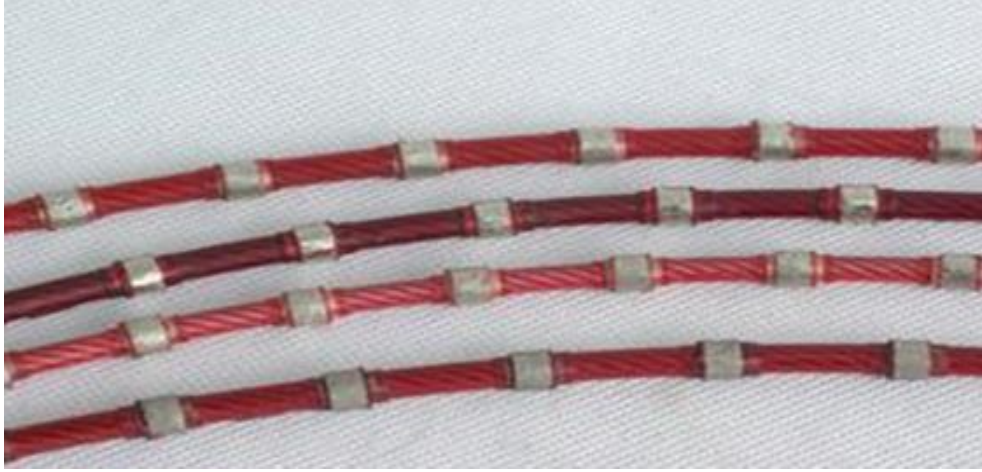
Şekil 2. 3 Granit türü sert kayaç kesiminde kullanılan elmas teller
