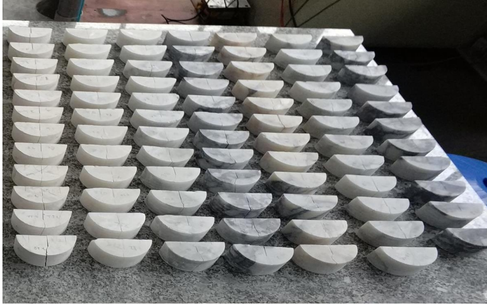
Şekil 4. 15 SCB numunelerinin kırıldıktan sonraki görünüşleri
