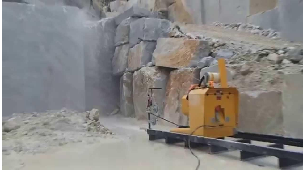
Şekil 2. 6 Raylı elmas telli kesme makinesi
