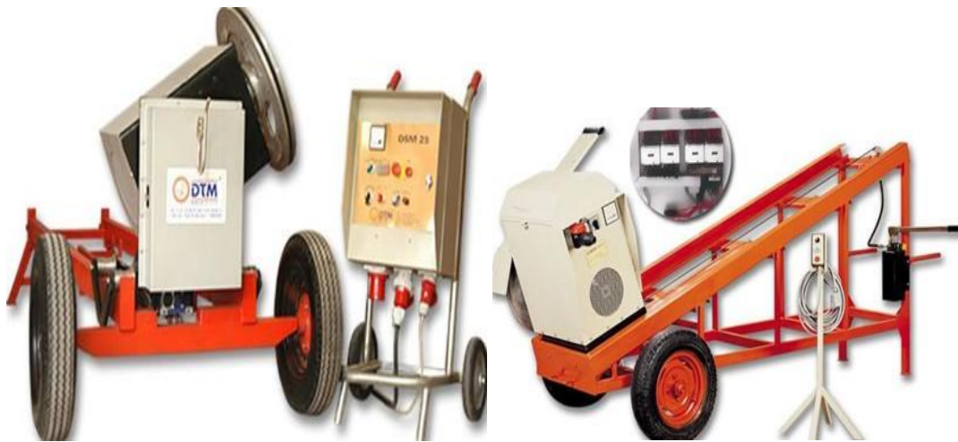
Şekil 2. 7 Tekerlekli elmas telli kesme makinesi ve rampalı sayalama makinesi
