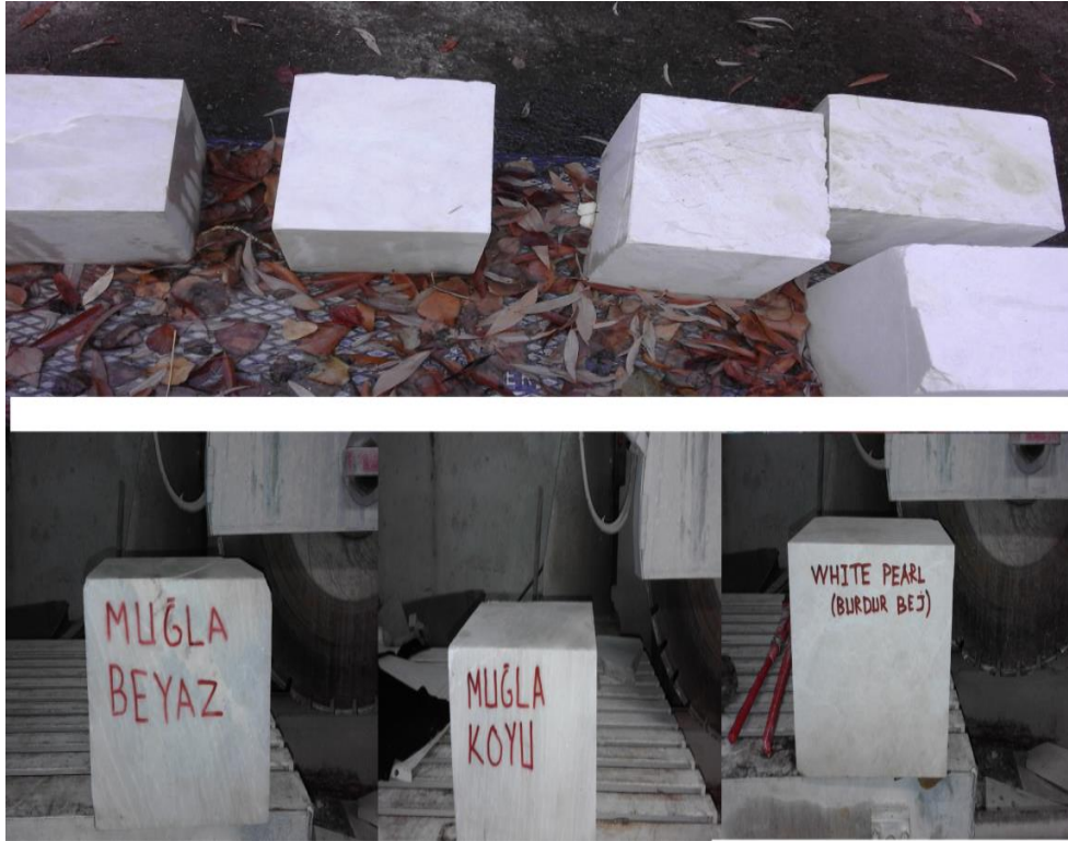
Şekil 4. 2 20cm*20cm*25cm ebatlarında boyutlandırılmış numunelerin bazılarının görünümü
