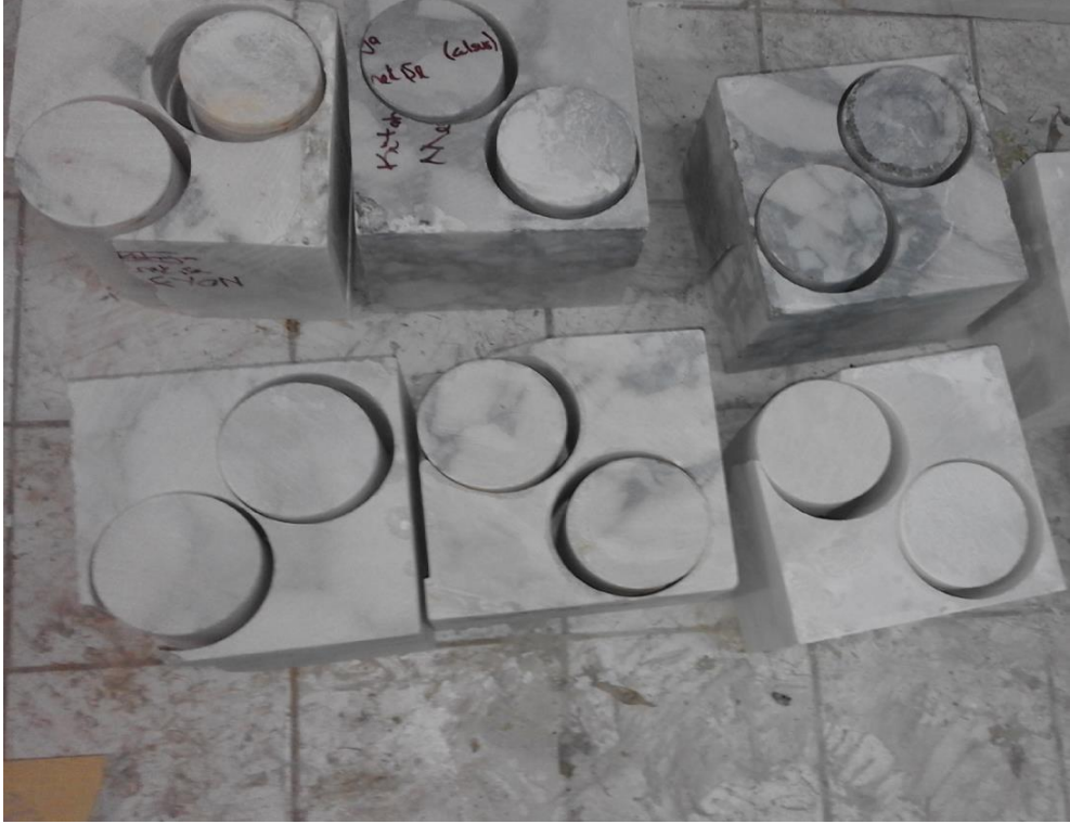
Şekil 4. 4 Doğal taşların karot aldıktan sonraki görüntüsü
