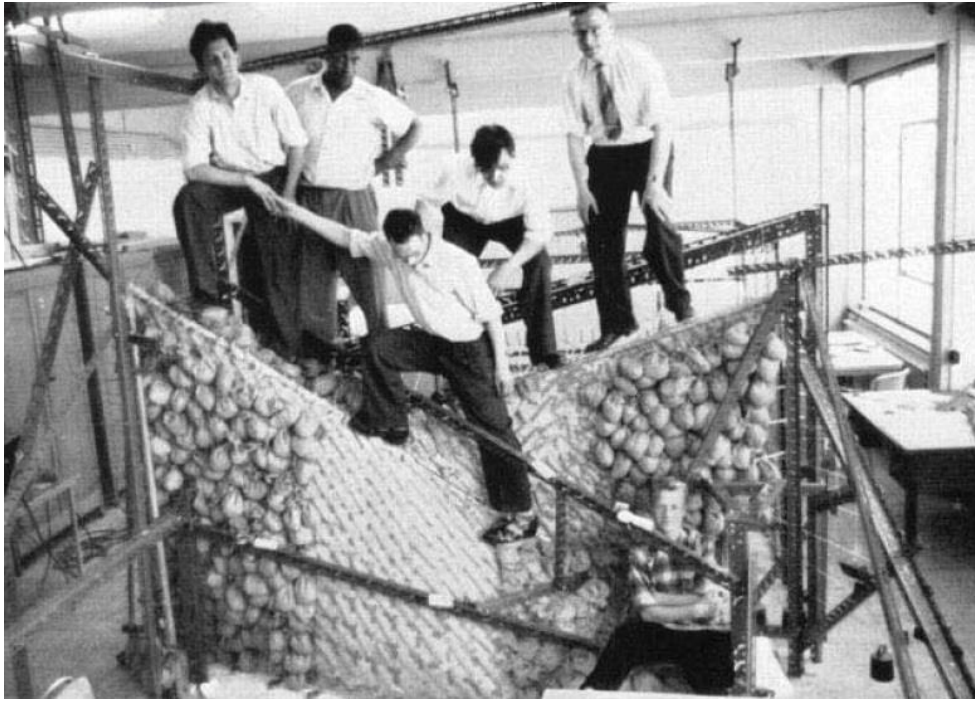
Figür 3.23. Philips pavyonu inşaatı öncesi maket üzerinde basınç testi esnasında çekilmi fotoğraf (Yılmaz, 2008, s.37).
