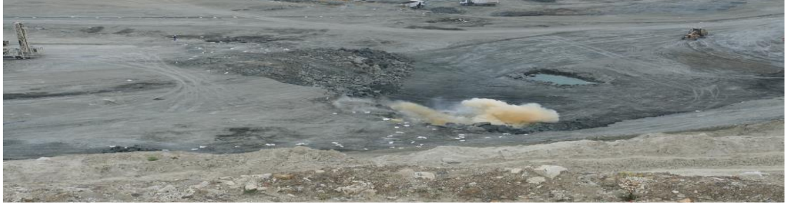
Şekil 5.6 Yetersiz yemeleme nedeniyle infilak edemeyen ANFO'nun yanması sonucu turuncu gaz oluşumu
