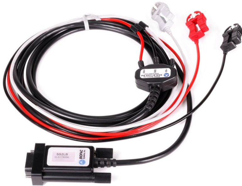
Şekil 3-9: BIOPAC SS2LB Ölçüm Kablosu
