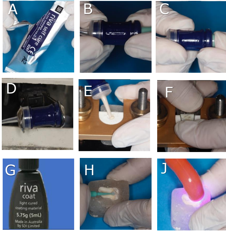
Şekil 3.6. Riva self-cure materyalinin uygulanması A: Kapsülün ambalajının yırtılması, B-C:Kapsül pistonuna bastırılması, D: Kapsülün amalgamatöre yerleştirilmesi, E: Materyalin tabancası aracılığı ile örnek üzerine yerleştirilmesi, F: Şeffaf bant ve lam aracılığı ile hafif parmak basısı uygulanması, G-H:Riva Coat uygulanması, J:Riva Coat'un polimerize edilmesi
