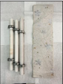
Teflon rulo - PVC bant ve ölçülen değerler
