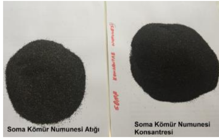
Şekil 5.27. Soma kömür numunesi ayırım sonrası görüntüsü
