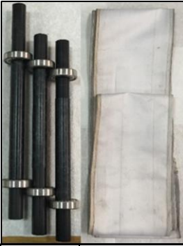
Delrin rulo - naylon bant ve ölçülen değerler
