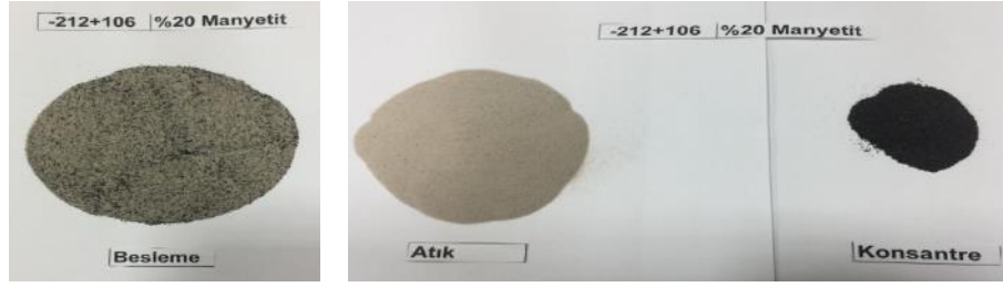
Şekil 5.14. -212+106 \mu\text{m} fraksiyonu %20 manyetit içeren besleme ve test sonucu üretilen ürünler
