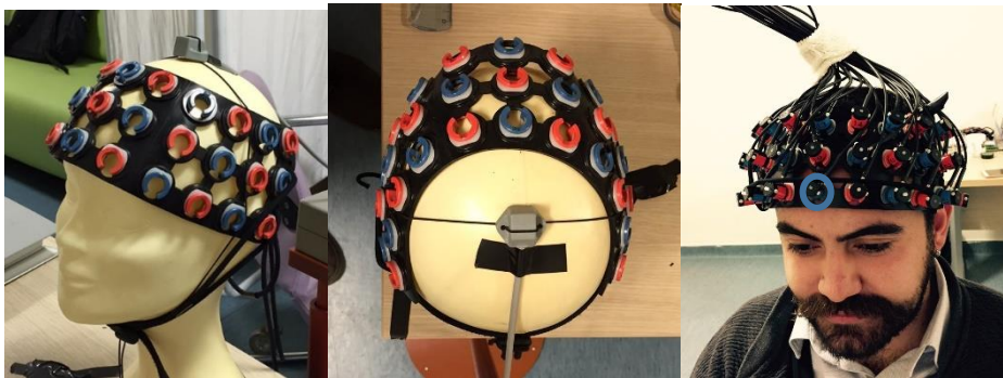
Şekil 6. Çalışmada kullanılan 3x11'lik 52 kanallı prob seti ve uygulanışı.
