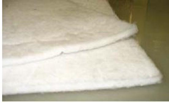
Şekil 3.2. Plastik elyaf tipi Polietilen tereflat (PET) malzeme örneği [26]
