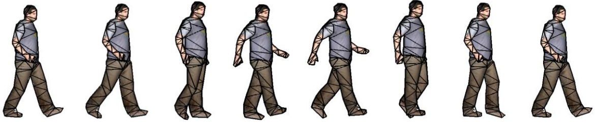
Şekil 2.24 Modelin farklı uzuvlarına ait impostor resimlerinin farklı animasyon pozları için deforme edilerek kullanılması [95]
