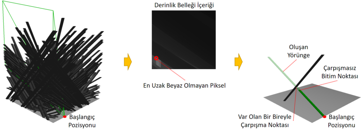
Şekil 5.6 Siyah pikselin derinlik değeri ve pay katsayısı kullanılarak yörünge parçasının bitim noktasının belirlenmesi
