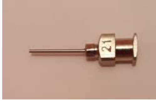
Şekil 3.7. Elektroğirme işleminde kullanılan 21 gauge'lik paslanmaz çelik iğne.
