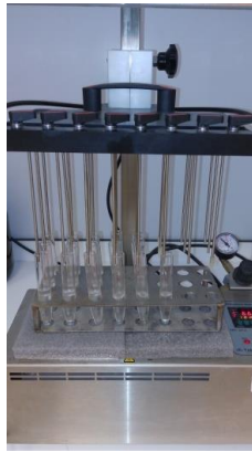
Şekil 3.2. Toplanan organik fazların azot uçurma sistemine yerleştirilerek buharlaştırılma düzeneği.
