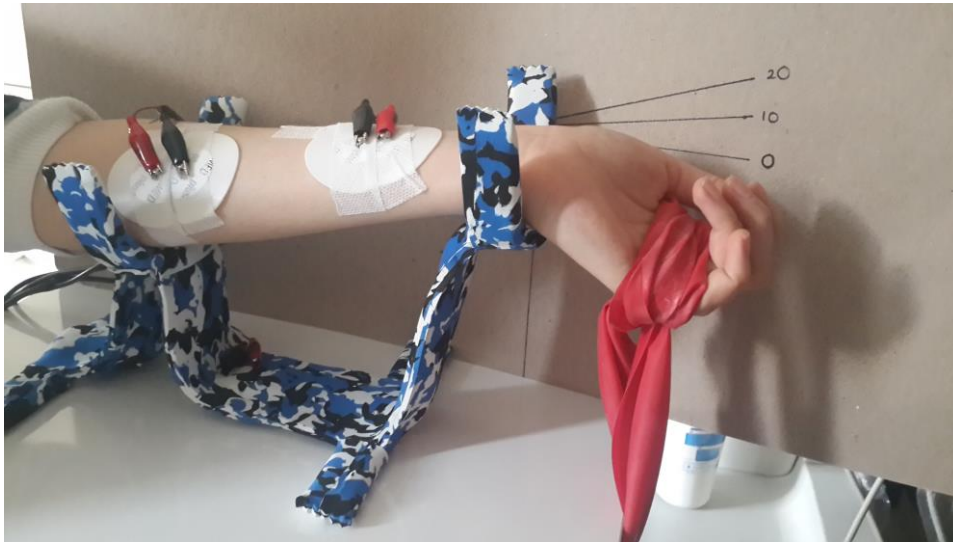
Şekil 3.7. El bileği fleksiyon hareketi sırasında EMG ölçümü.
