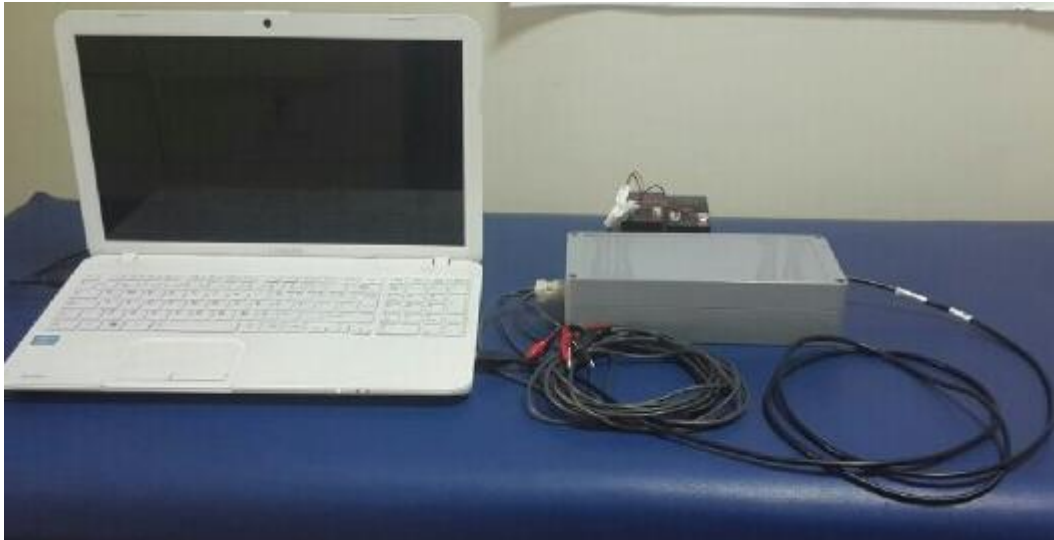
Şekil 3.2. Yüzeysel EMG ölçüm sistemleri.
