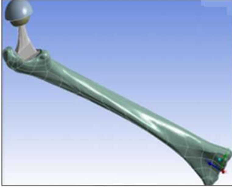
Şekil 13.Kemik ve Protez Montajı, Signh ve Harsha, 2016
