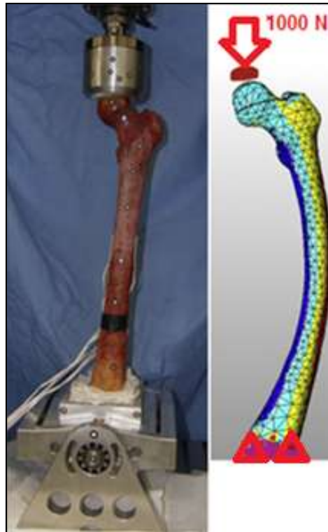
Şekil 9.Deforme Femur Deney Düzeneği ve FEM analizi N. Trabelsi ve diğerleri, 2011
