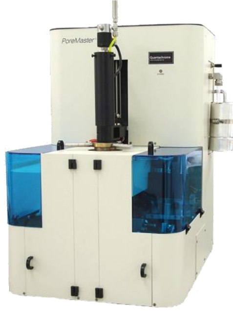
Şekil 3.13 Civa porozimetresi yöntemi ile gözenek boy dağılım tayininin ve gözenek boy dağılım değerinin ölçüldüğü Quantachrome Corporation, Poremaster 60 model cihaz
