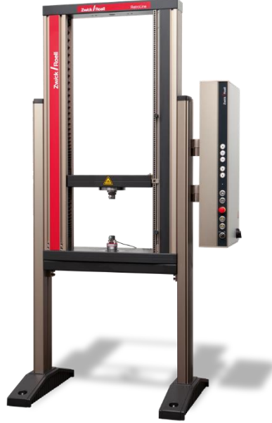
Şekil 3.12. Monolitlerin çapraz bağ yoğunluğunun belirlenmesi için yapılan mekanik testlerde kullanılan Zwick Z010 model malzeme test cihazı
