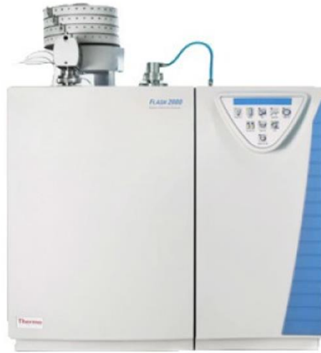
Şekil 3.14. Monolitik yapıya bağlanan ligand içeriğinin tayini için kullanılan Thermo Scientific, Flash 2000 model elementel analiz cihazı
