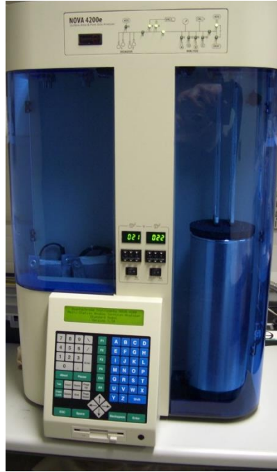
Şekil 3.11. Monolitlerin özgül yüzey alanı tayinini gerçekleştiren Quantachrome Nova 2200 model BET cihazı.
