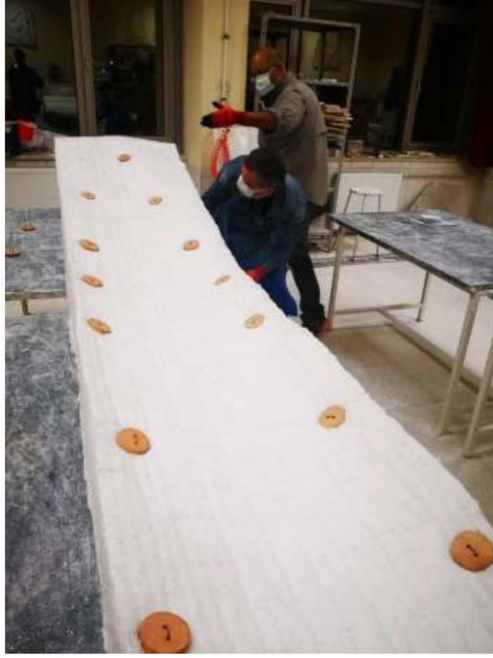
Görsel 100. Taç yaprak fırın yapımı ve yaprağın elyafla döşenmesi II Kişisel arşiv
