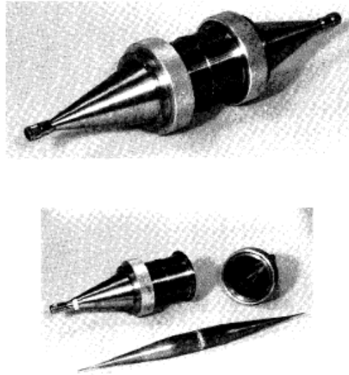
Şekil 3.5. Sürekli İletken Dairesel Eş Eksenli Tutucu [12].
