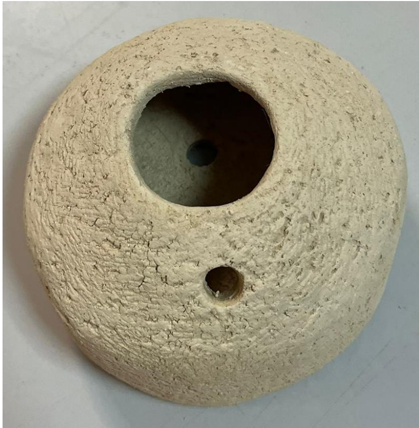
Görsel 22-a1. Baştankara yuva uygulaması (Bisküvi) Ölçüler: 11cm - 11cm - 3cm; İki ürün şamotlu kil, iki ürün şamotsuz beyaz kilden yapılmıştır. Plaka yöntemi ile elle şekillendirme. Fotoğraflar 10.06.2024'te çekilmiştir.
