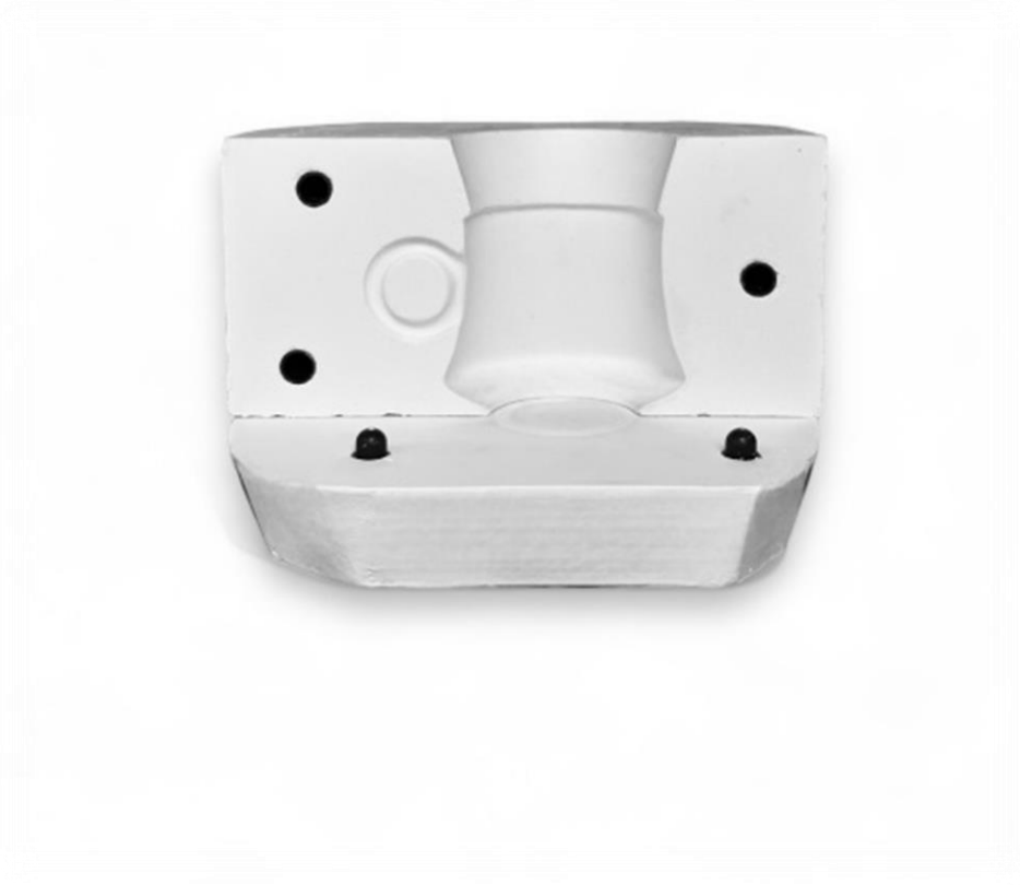
Görsel 5: Endüstriyel Seramik Üretim Malzemelerine Örnek, Bal dudak Alçı Tasarım Fincan Kalıbı, 30cm x13cm x 10cm Çağrı ATASAYAR, Kişisel Fotoğraf Arşivi, 2024.
