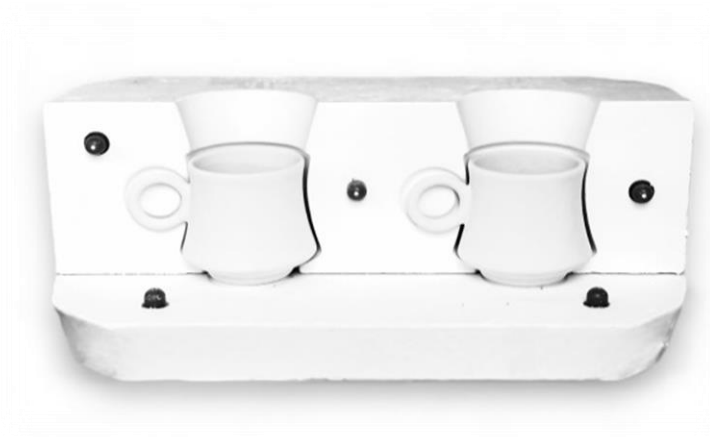
Görsel 8: Endüstriyel Seramik Üretim Malzemelerine Örnek, Bal Dudak Alçı, Çift Bataryalı Kalıp İçerisinde Seramik Döküm Çamuru Dökülmüş ve Sertleşmiş Pişirim yapılmamış Tasarım Fincan, 6cm x9cm x 5cm Çağrı ATASAYAR, Kişisel Fotoğraf Arşivi, 2024.
