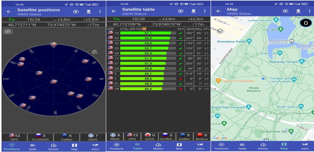
Şekil 4.10 Sahtecilik Aldatma Saldırısı ile İç Ortamda Cep Telefonu Aldatma Deneyi Uzak Mesafe
