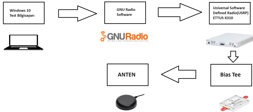
Şekil 4.1 USRP ile Veri Toplama Sistem Modeli
