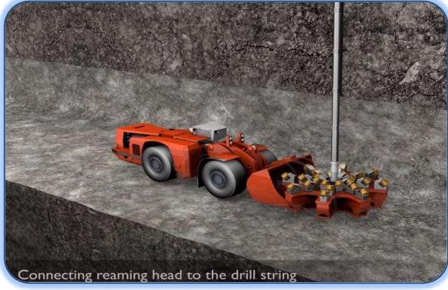
Şekil 4- 30:Kılavuz matkap ucu ve tarayıcı kafa deęiřimi
