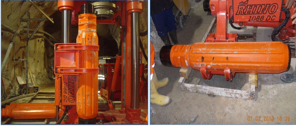
Şekil 4- 13 :Boru tutucu ile dengeleyici borunun sondaj dizisine eklenmesi
