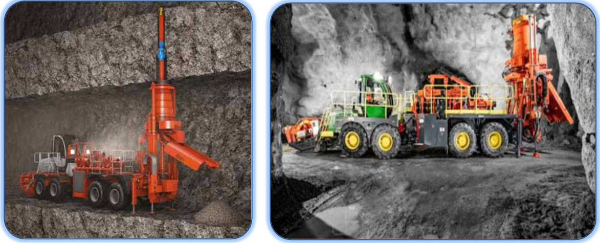
Şekil 3- 12 :Rhino 100 başyukarı delgi çalışması ve kurulum aşaması [10]
