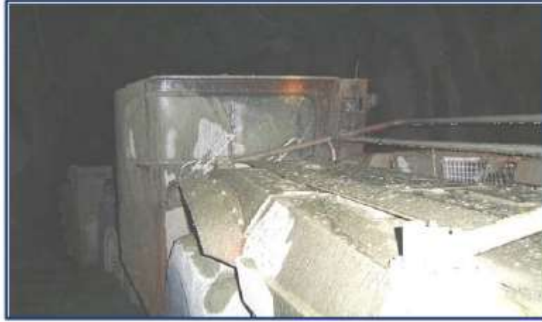
Şekil 7- 8: Tarama aşamasında ani su boşalması nedeniyle yükleyicinin çamurla dolması [30]
