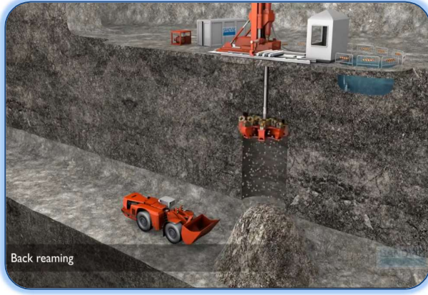
Şekil 4- 32: Kazı sırasında zaman zaman yapılan pasa alma işlemi
