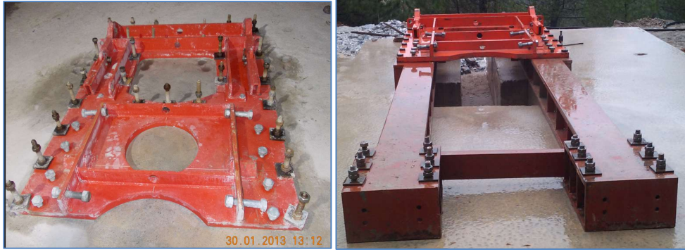
Şekil 4- 20 : BKAM taban platformu ve yükseltici kiriş üzerine monte edilmiş kiriş platformu
