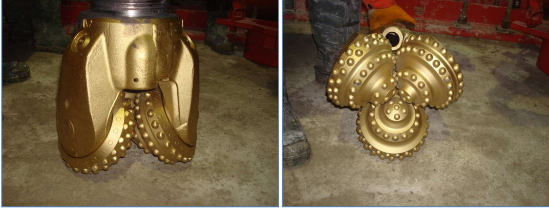
Şekil 4- 7 :Tricone kılavuz matkap ucu (311 mm)
