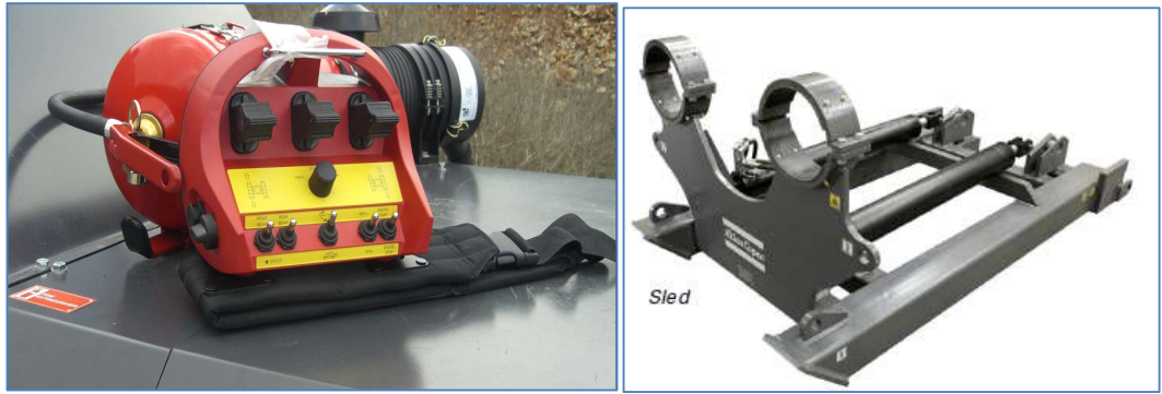
Şekil 4- 23 : Taşıyıcı kumanda paneli ve taşıyıcı kızak
