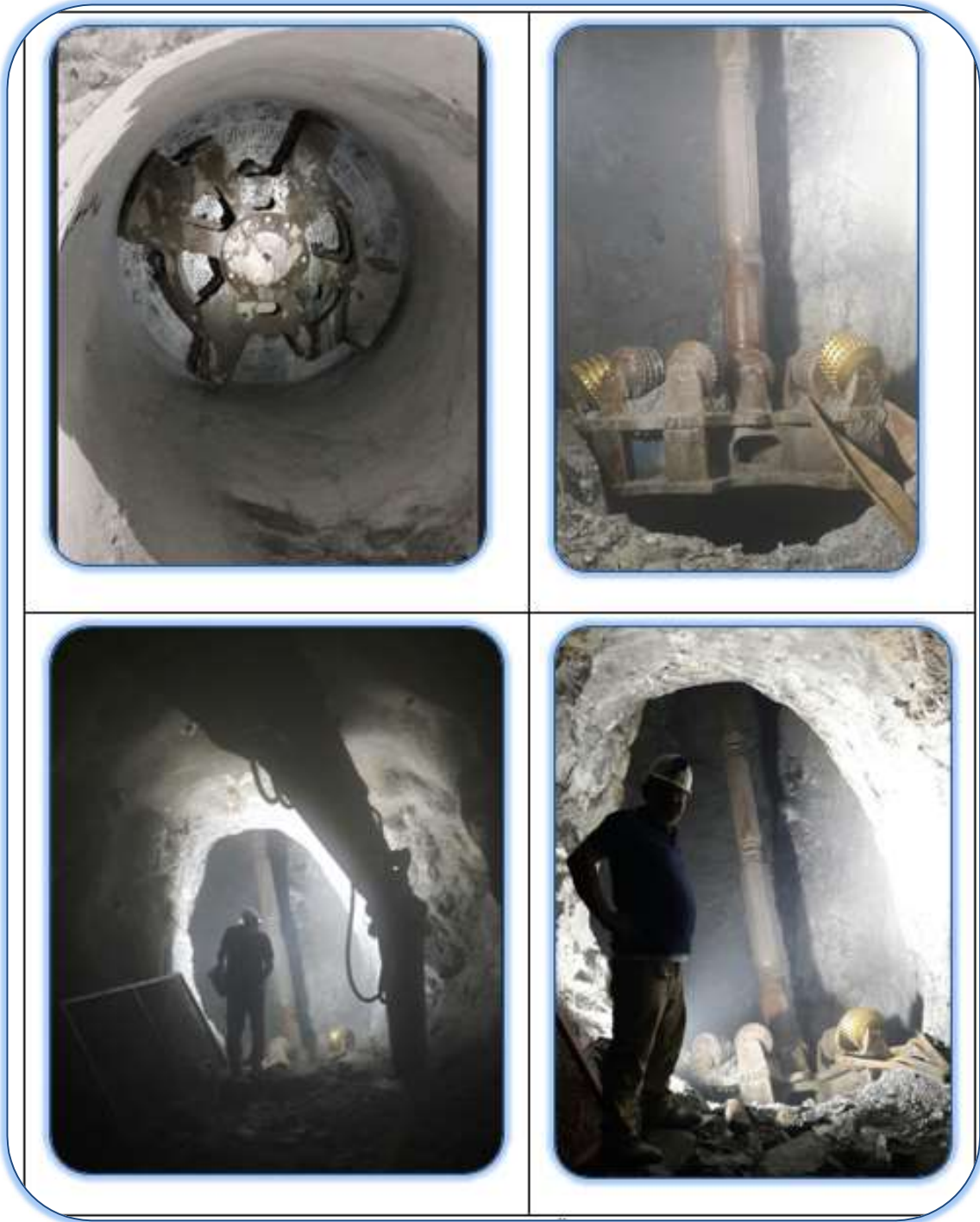
Şekil 7- 7: Erişim galerisi açılara tarayıcı kafa üzerindeki kesicilerin değiştirilmesi
