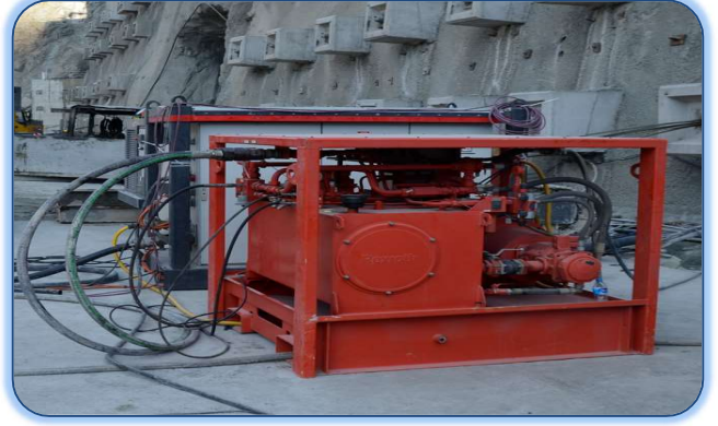
Şekil 4- 26: Elektrik ve hidrolik güç üniteleri bağlantısı
