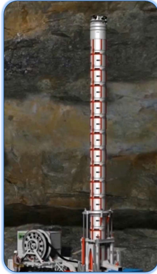
Şekil 2- 5 :Borulmalı yukarı tarama kuyusu [4]
