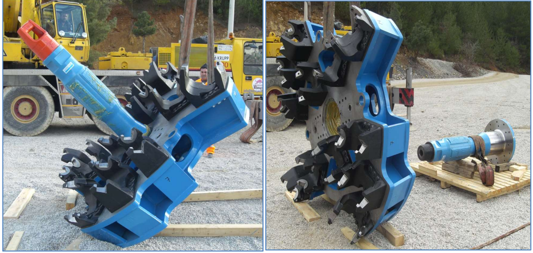
Şekil 4- 15 :Tarayıcı kafa ve stem bağlantısı
