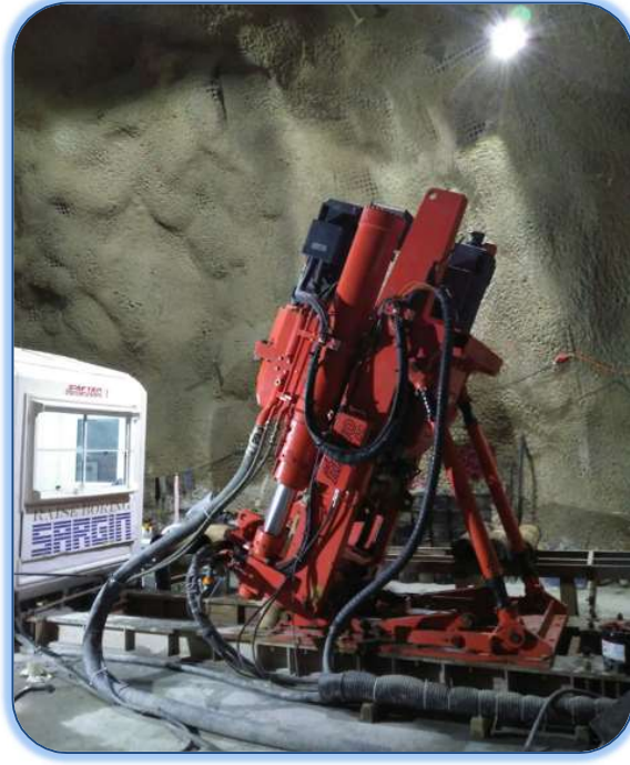
Şekil 7- 2: Eğimli Kuyu (Eğim açısı 68°)
