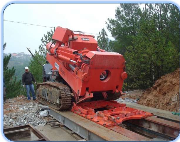
Şekil 4- 28: Taşıyıcı ile platform üzerine çıkış
