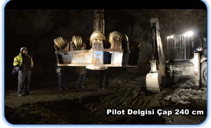
Şekil 4- 30:Kılavuz matkap ucu ve tarayıcı kafa deęiřimi
