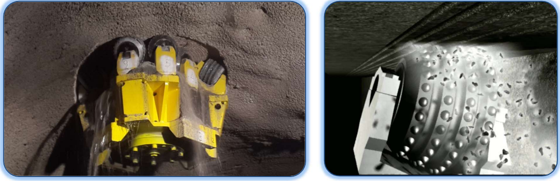
Şekil 4- 2 :Tarayıcı kafa ve kesme mekanizması [1]
