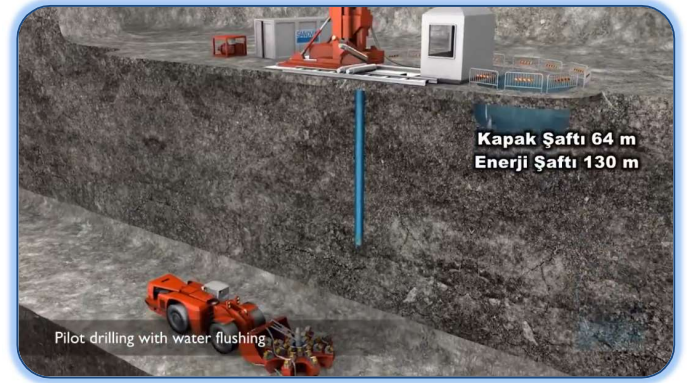
Şekil 4- 28: Kılavuz delgi aşaması
