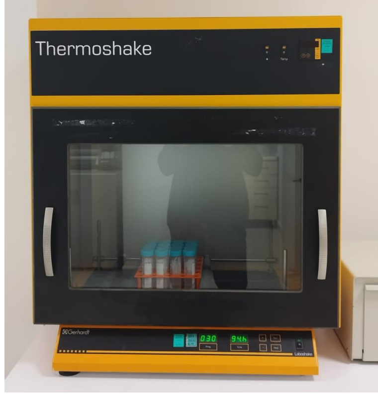
Şekil 3.20. Plakalar sürekli çalkalamalı sistemde laktatlı ringer çözeltisinde.
