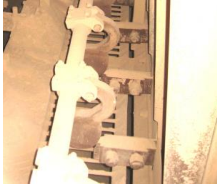
Şekil 4.5. Elektrostatik çöktürücülerin toplayıcı plakaları çırpma sistemi [31]
