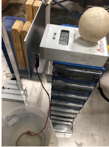
Şekil 5.12. Statik yükün arttırılması amacıyla kullanılan tuzlu su bağlantısı
