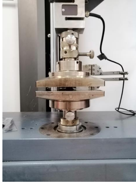
Şekil 3.10. 10 kN yük hücresi ve ona bağlı olarak çalışan sıkıştırma test aparatı
