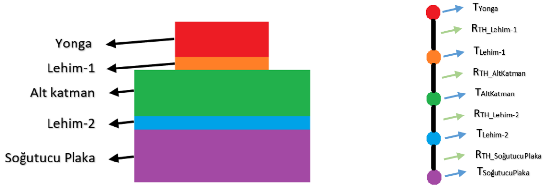
Şekil 2.3.5. Modül katmanları ve termal eşdeğer devresi
