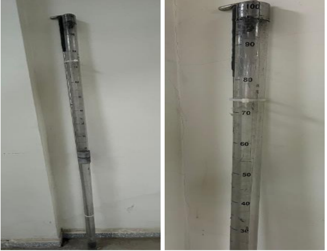
Şekil 3.6 Hava hızı ölçüm ekipmanı
