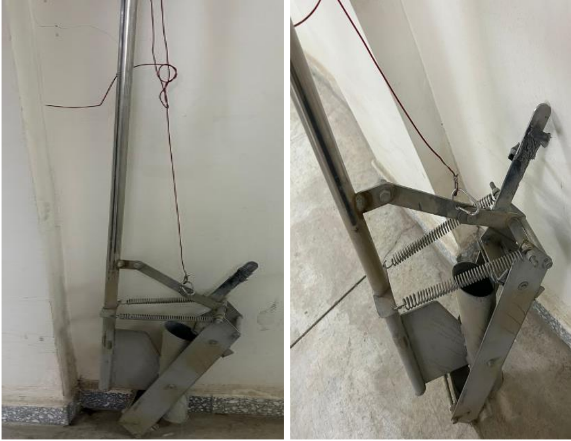
Şekil 3.7 Hacimsel hava miktarı ölçüm ekipmanı
