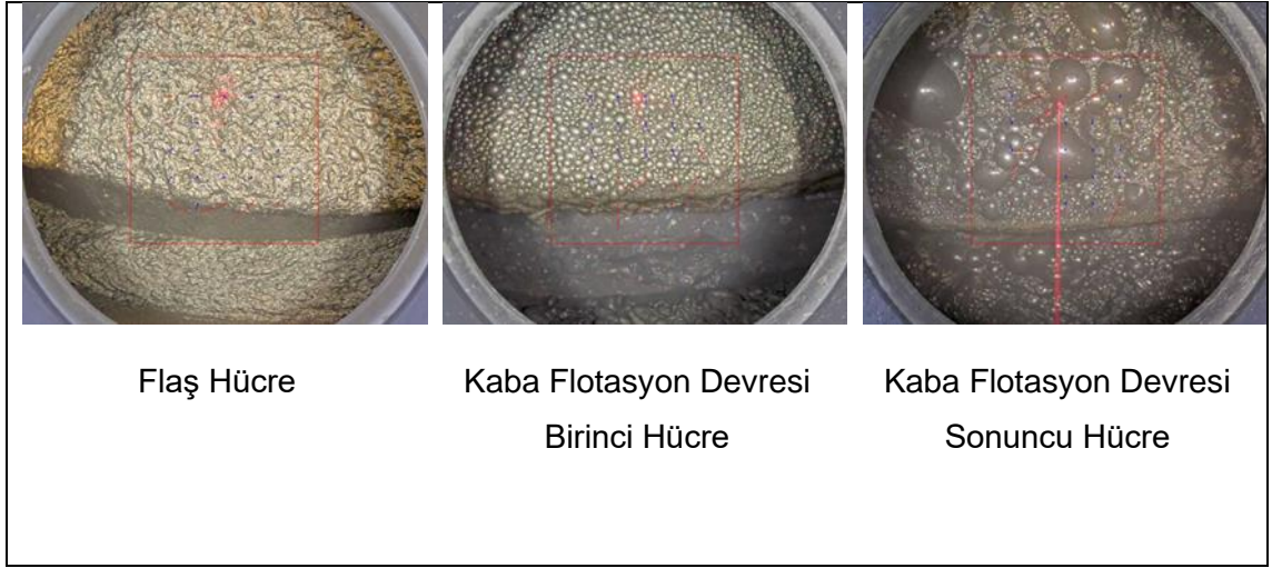
Şekil 3.2 İncelenen hücrelerin köpük görüntü sistemi tarafından görüntülenen köpük yüzey görüntüleri
