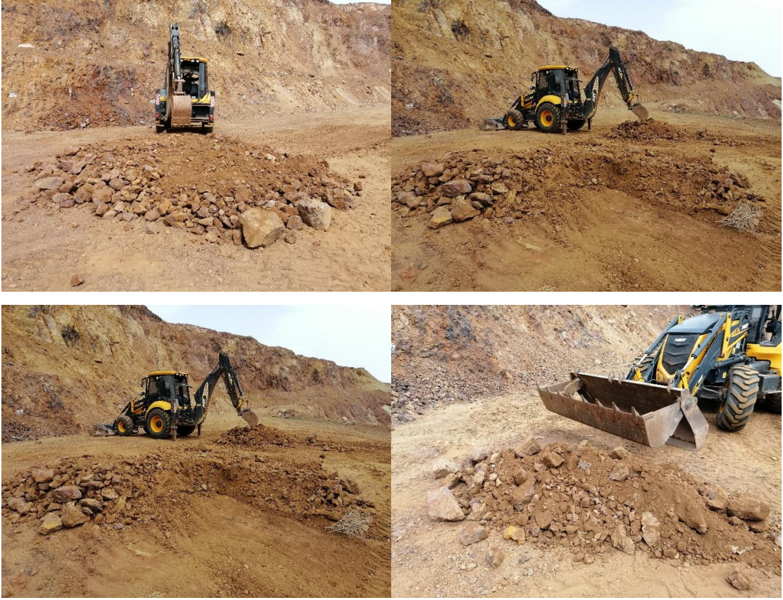
Şekil 3.6 Sahada numune azaltma işlemlerini gösteren fotoğraf görüntüleri
