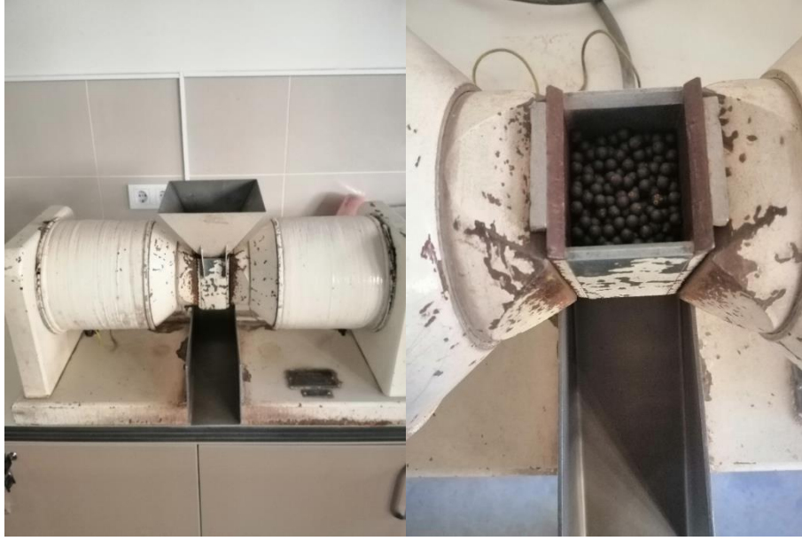
Şekil 3.24 Carpco yüksek alan şiddetli yaş manyetik ayırıcı
