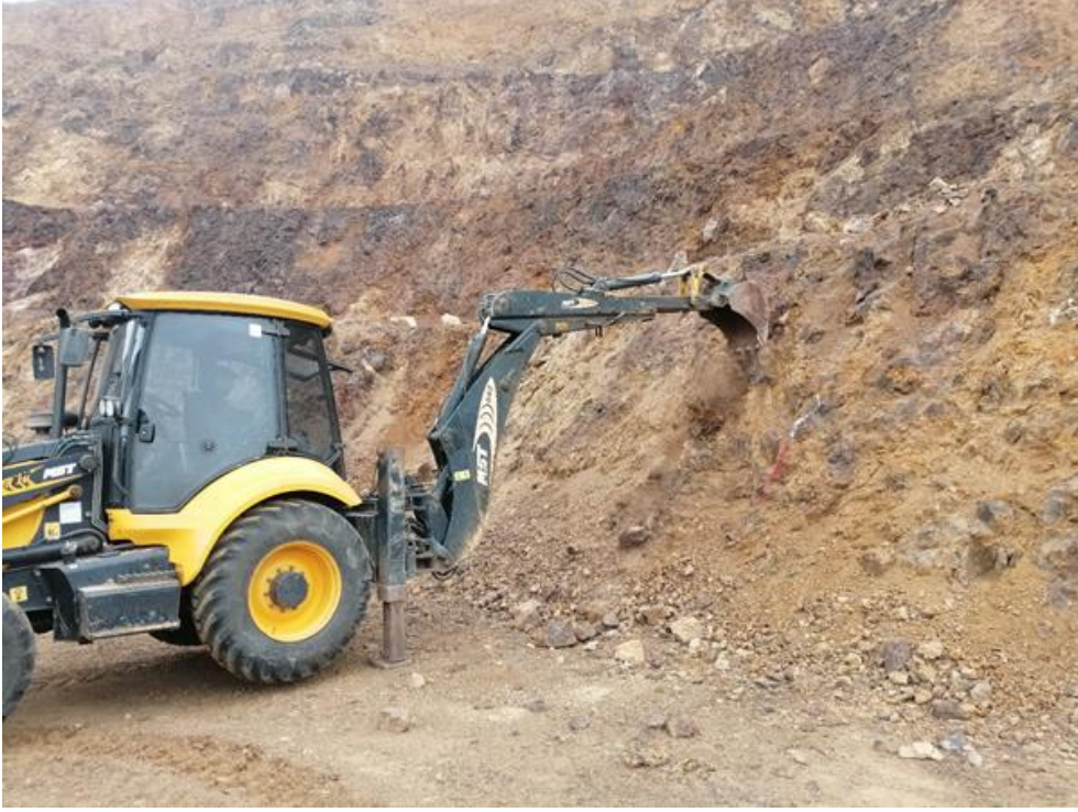
Şekil 3.2 Eski üretim basamaklarından iş makinası yardımı ile numune toplanması (1)
