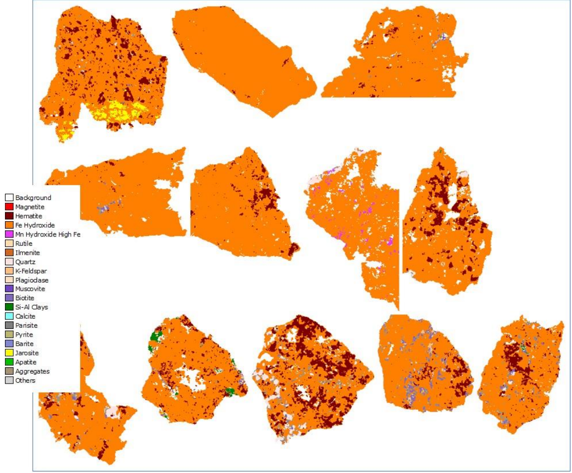
Şekil 3.11 Fe hidroksit minerallerine ait elektron mikroskop görüntüleri (-500+212 µm)
