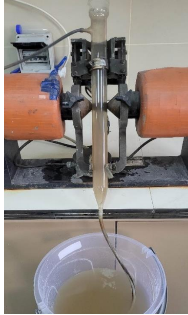
Şekil 3.12 Davis tüp test cihazına ilişkin görüntü
