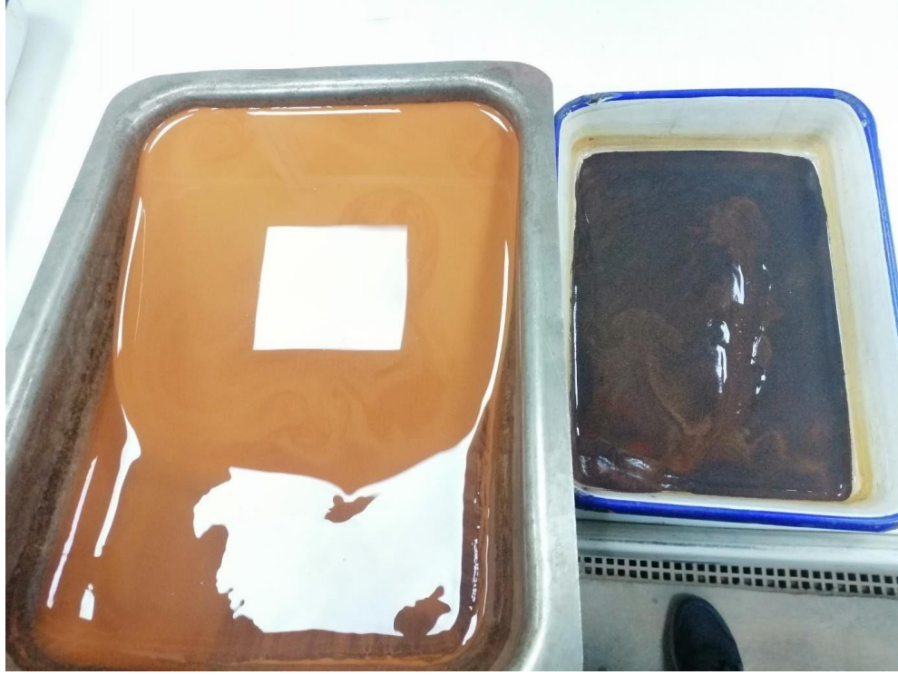
Şekil 3.34 Seçimli salkımlaştırma testine ait ürünler
