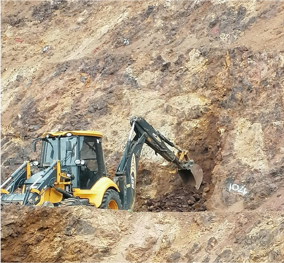
Şekil 3.3 Eski üretim basamaklarından iş makinası yardımı ile numune toplanması (2)
