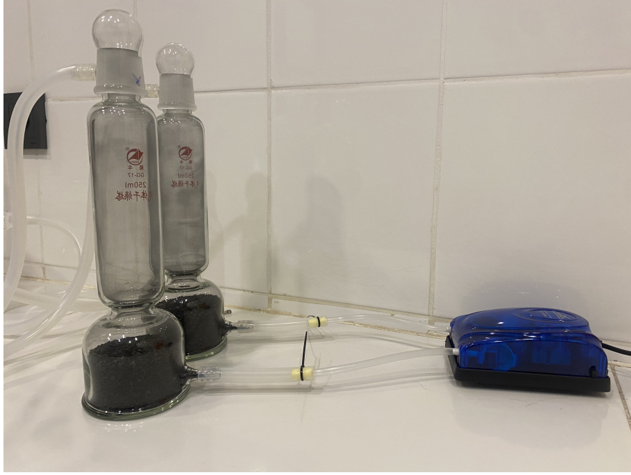
Şekil 2.2 Olfaktometre sistemine düzgün hava akışı sağlayan hava pompası ve filtre şişeleri.
