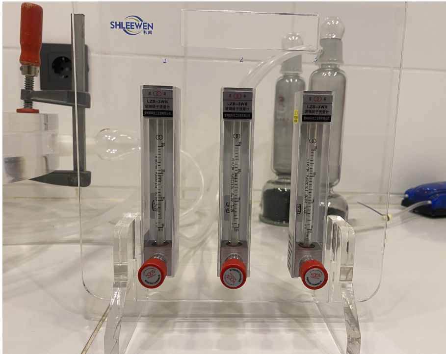
Şekil 2.3 Olfaktometre sistemine gönderilen hava akışının debisini ayarlayan debimetreler.
