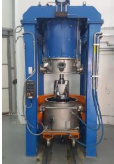
Şekil 3.13. Dökülebilir patlayıcı üretimlerinde kullanılan örnek karıştırıcı-reaktör sistemi ve karıştırıcı
