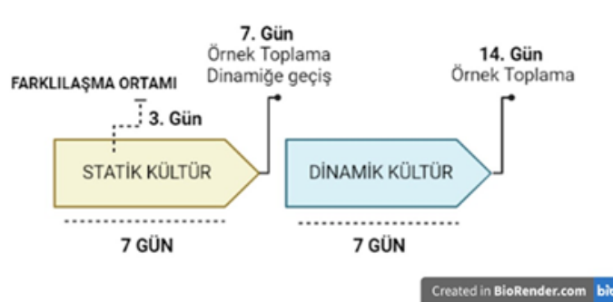
Şekil 3.3. Biyoreaktörde hücre kültürü için çalışma planlaması.
