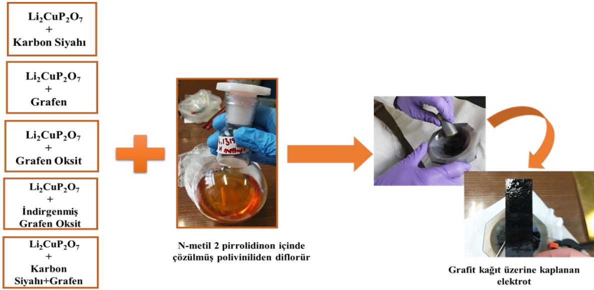
Şekil 3.1. Elektrot hazırlama süreci ve grafit kağıt üzerine damla döküm yöntemiyle hazırlanan elektrodun görüntüsü.
