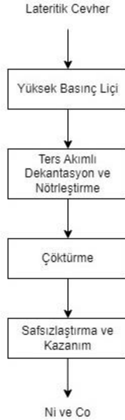
Şekil 2.5. YBAL prosesine ilişkin geliştirilmiş akım şeması
