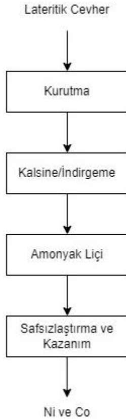
Şekil 2.4. Caron prosesine ilişkin genelleştirilmiş akım şeması
